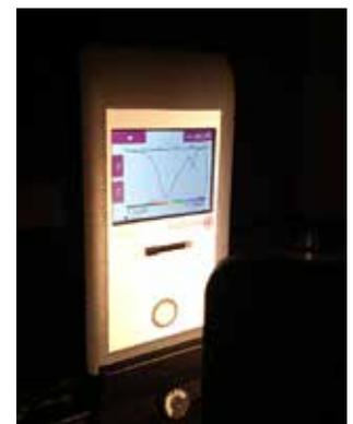
*Spektrometer direkt vor der LED zur Charakterisierung der Quelle. Links direkt vor der LED, Rechts mit 45° gedrehter LED.*
