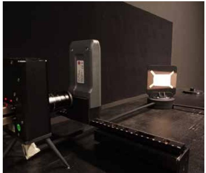
*Material seitlich angestrahlt zur Kontrolle des Reflexionsspektrums.*
