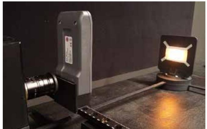
*MSC15 aufgebaut vor der Leuchtdichtekamera zur Kontrolle des Transmissionsspektrums.*
