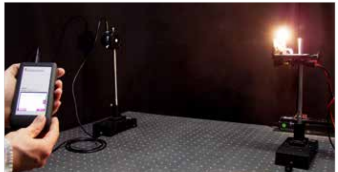
Der CSS-45 Sensor lässt sich getrennt vom Messgerät CSS-D in Anwendungen einsetzen.
