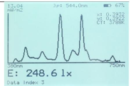
*Standarddisplay mit Beleuchtungsstärke, x,y Farbortkoordinate, Farbtemperatur und Emissionsspektrum einer Energiesparlampe*
