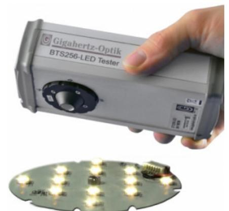
*BTS256-LED zur Vermessung von Lichtstrom, Spektrum, Farbe und Farbwiedergabe von Einzel-LEDs*
