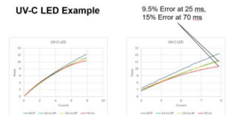
DCP-Methode (IES LM-92-22) Beispielmessung einer UV-LED
