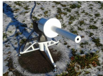
*SUT-1711 ausgestattet mit BTS2048-UV-S-WP und Tubus für die direkte Sonnenmessung*
