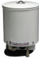
Wetterfestes Spektralradiometer für solare VIS Messungen
