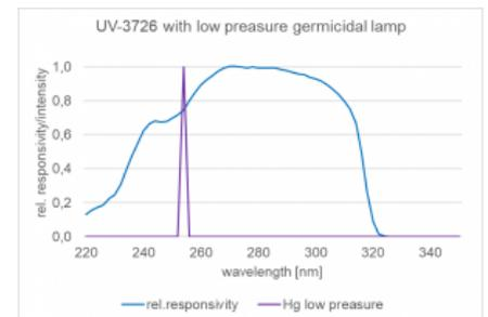
Typische spektrale Empfindlichkeit des UV-3726-Detektors zusammen mit dem Emissionsspektrum einer keimtötenden Niederdruck-Hg-Lampe bei 254 nm.
