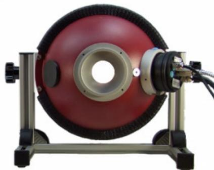
*X4 Detektorkopf an einer Ulbrichtkugel*
