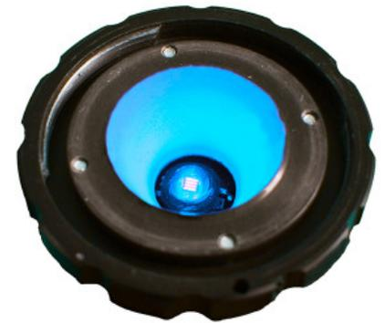
El puerto de medición cónico se coloca sobre el LED de prueba y detecta toda la radiación en un espacio de 2pi
