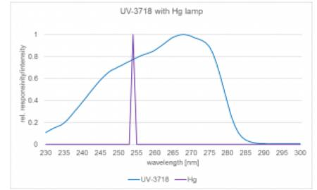
UV-3718 检测器的典型光谱灵敏度以及低压汞杀菌灯在 254 nm 的发射光谱。
